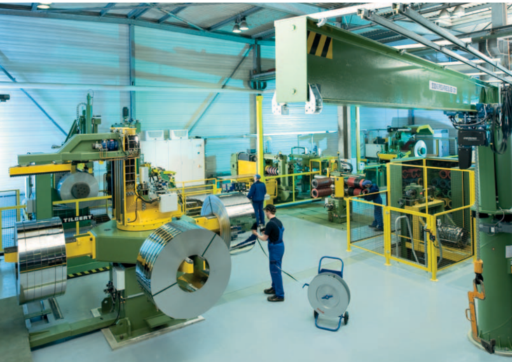
Gesamtanlage mit Bundaufnahme für zwei Coils mit Maximalgewichten von bis zu 12 Tonnen. (Bilder: Vogel-Bauer)
