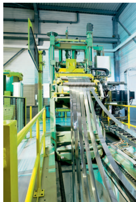
Bremsgerüst am Auslauf der 12 Meter tiefen Schlingengrube.
