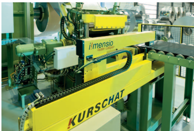
Berührungslose Dicken- und Profilüberwachung mit einem Lasermessbügel.
