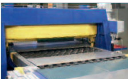
Maßgefertigte Präzisionsplatinen nach individueller Kundenvorgabe, kratzerfrei und kantengenau abgestapelt.
