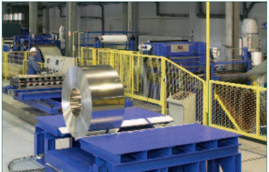
Auf der größten Querteilanlage bei Vogel-Bauer werden Platinen präzise mit engen Längentoleranzen geschnitten.
