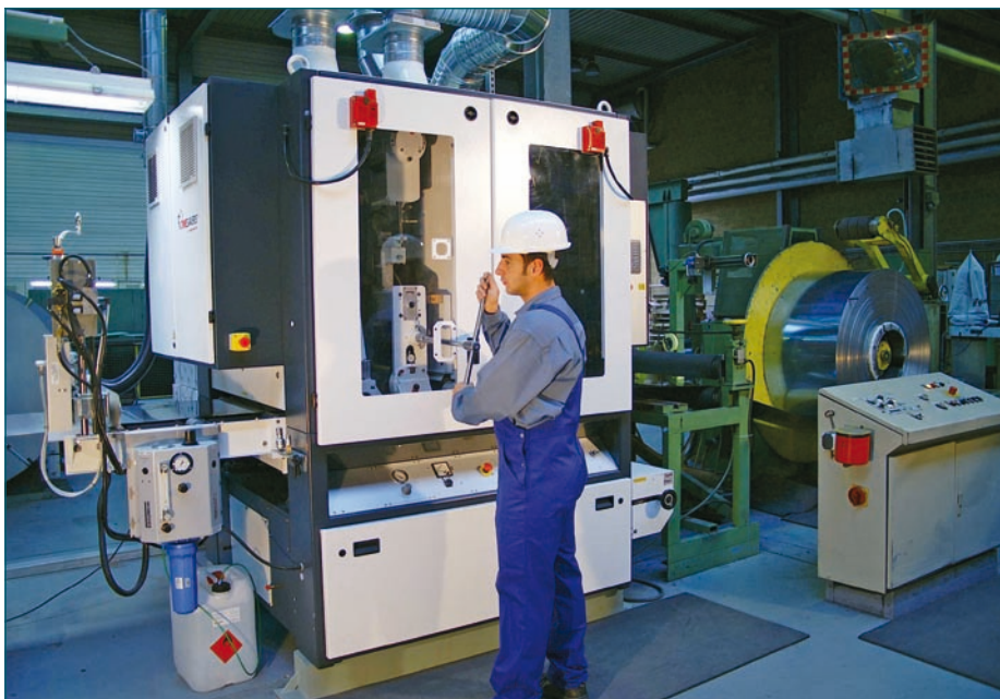
Auf der neuen, kombinierten Coil-, Schleif- und Bürstanlage lassen sich Edelstahloberflächen mit dem so genannten „Hairlinefinish“ veredeln (Bilder: Vogel-Bauer)
