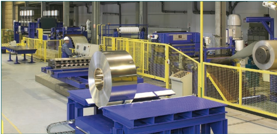
Auf der größten Querteilanlage im Hause werden unter Einhaltung enger Längstoleranzen Platinen mit präziser Schnittausführung und exakter Rechtwinkeligkeit erzeugt
