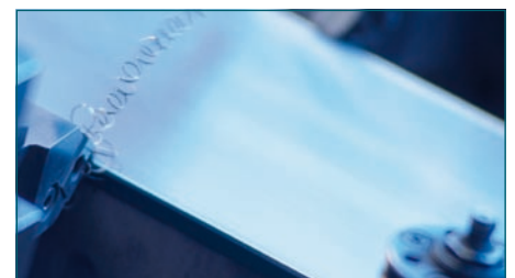
Optional können die Schnittkanten an Spaltbändern bearbeitet werden, entweder unter Spanabnahme (hier: Entgraten) oder mittels Kaltumformung
