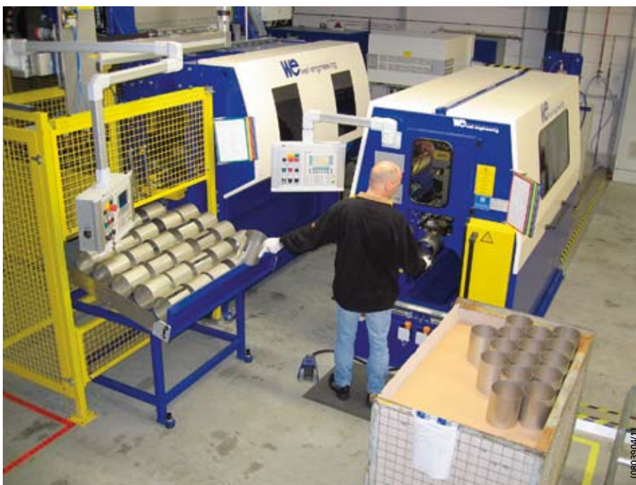
Hohe Effizienz und bewährte Prozesssicherheit: Nach dem CNC-gesteuerten Runden der Edelstahlzuschnitte erfolgt das hochpräzise Längsnaht-Laserschweißen (Foto: Michel- felder).
