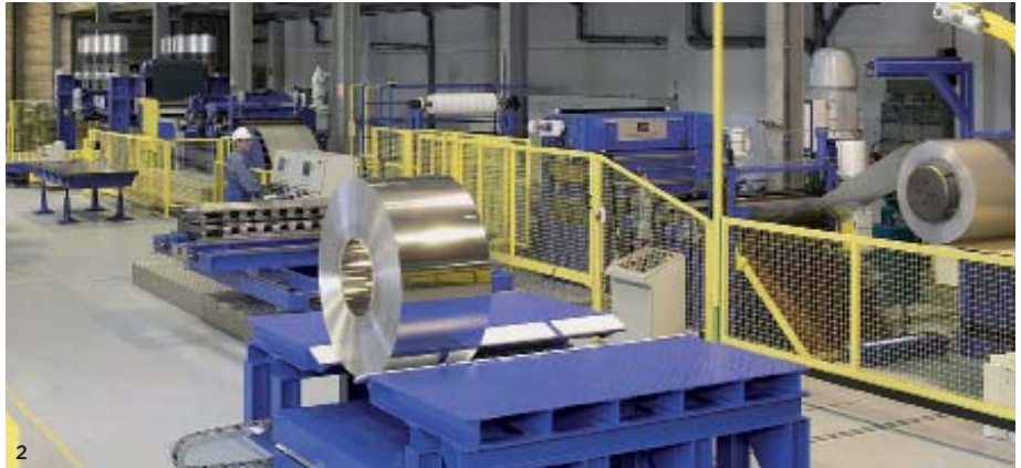
1 Die erste Längsteilanlage produzierte Spaltbänder. 2 Auf der Querteilanlage werden Edelstahl-Platinen mit präzisiertem Schnitt und Winkel erzeugt.
