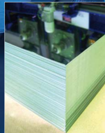
Maßgefertigte Präzisionsplatinen werden nach individueller Kundenvorgabe kratzerfrei, kantengenau und sorgfältig abgestapelt.
