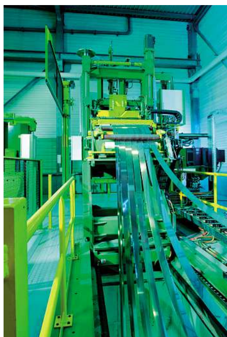
Bremsgerüst am Auslauf der 12 m tiefen Schlingengrube.
