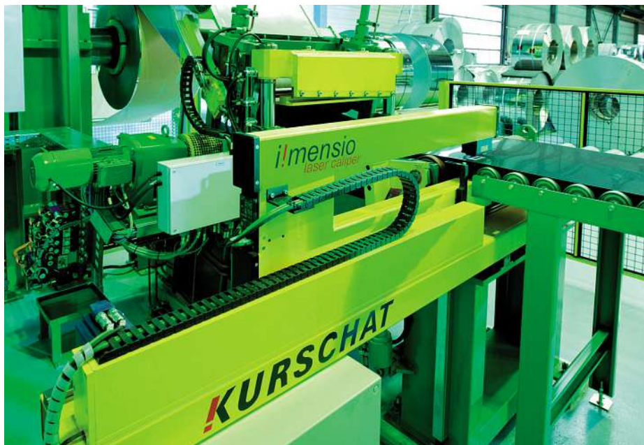
Berührungslose Dicken- und Profilüberwachung mit einem Lasermessbügel.
