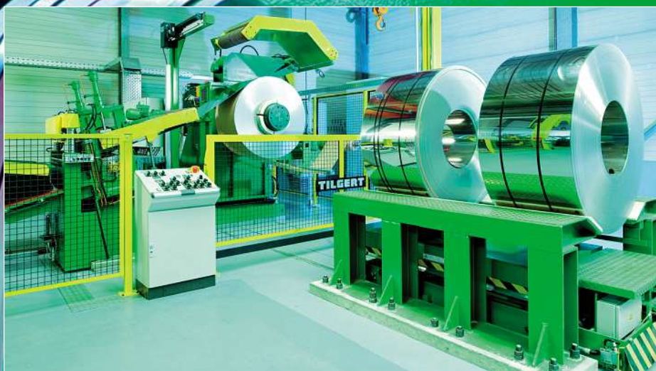
Bundaufnahme für zwei Coils mit Maximalgewichten bis 12 t.
