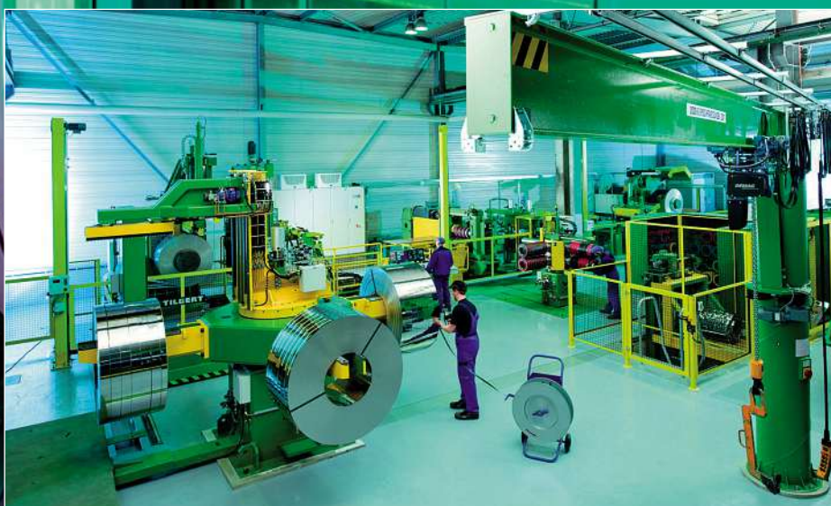
Gesamtansicht der neuen Längsteilanlage mit der Aufwickelgruppe im Vordergrund.
